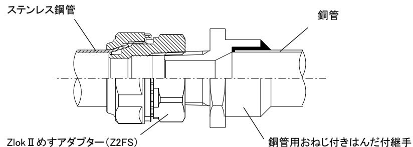
図5 銅管用はんだ付け継手とZlok IIを組み合わせた接続例
