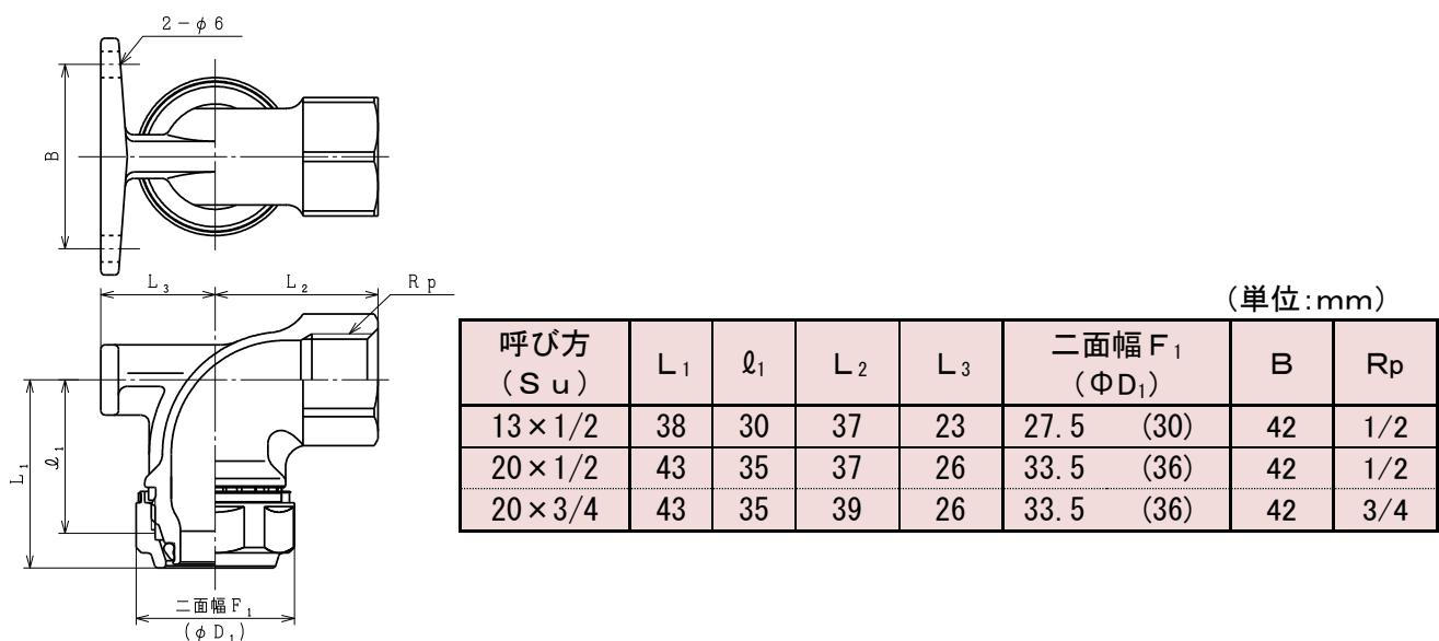
※記載の全長(L<sub>1</sub>、L<sub>2</sub>、L<sub>3</sub>)、外径(ΦD<sub>1</sub>)、高さ(A)およびピッチ(B)については、参考寸法です。
