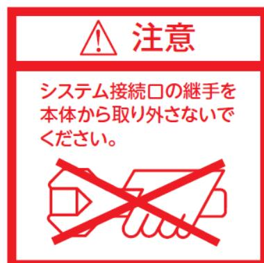
図 5-3 システム接続口アダプタ分解防止
