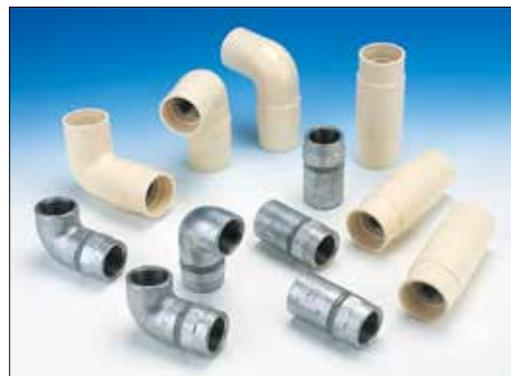
絶縁継手Ⅱ型は、ガス配管に使用しコンクリートと土壌との間で形成される電位差に起因する腐食を防止する目的で開発された、管路を電氣的に絶縁する継手です。
